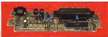
Ecco l'interfaccia aperta. Sotto il connettore, 28 x 28 poli Cx la ROM da 6K.
